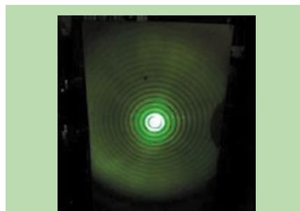
Настоящий диск Эйри, созданный прохождением лазерного луча через точечное отверстие
