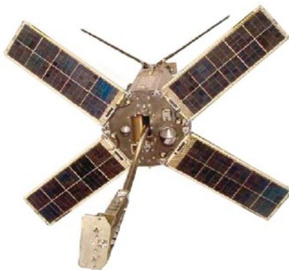
Рис. 1. Общий вид микроспутника «Колибри-2000» общей массой 20,5 кг с комплексом научной аппаратуры (3,8 кг), 4-мя солнечными панелями и гравитационной штангой.
